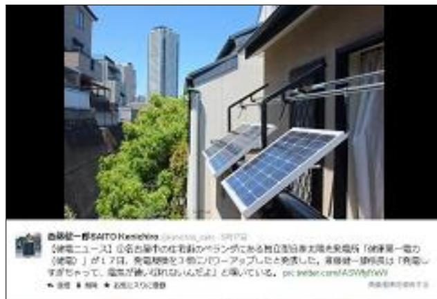
これは僕のツイッターの写真です。ベランダにソーラーパネルを3枚立てて、物干し竿に金具で固定しています。結構日が当たっているでしょう。
